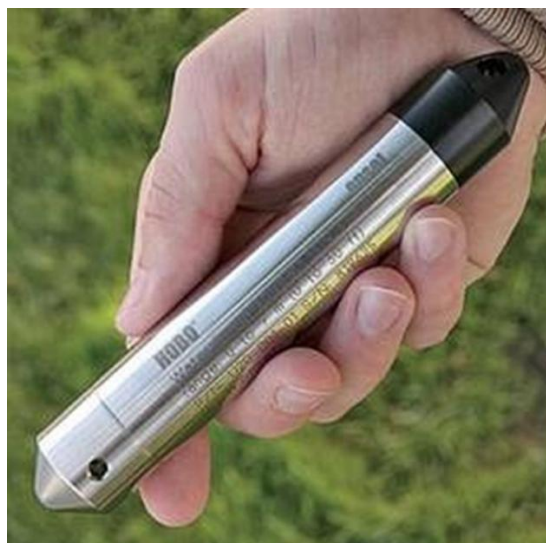
圖十、HOBO U20 自記式水位計
