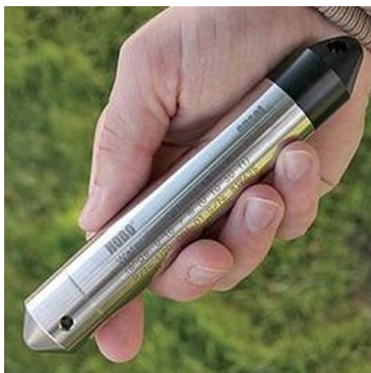
圖十、HOBO U20 自記式水位計
