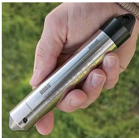
圖十、HOBO U20 自記式水位計
