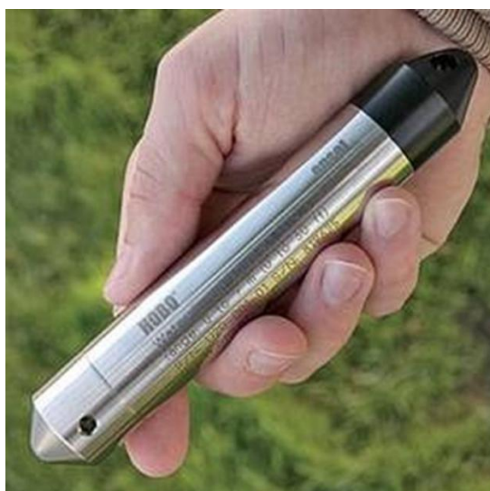
圖十、HOBO U20 自記式水位計
