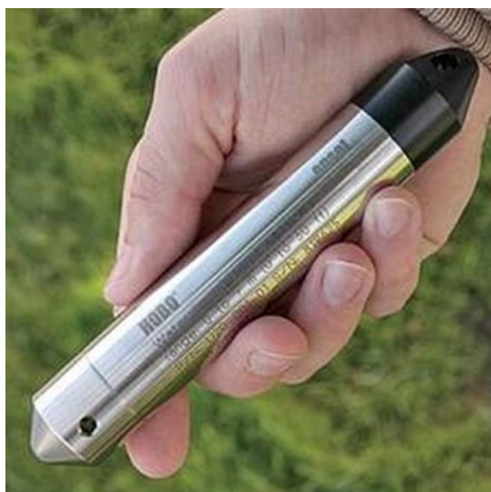
圖十、HOBO U20 自記式水位計
