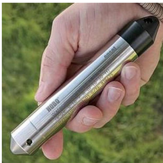
圖十、HOBO U20 自記式水位計
